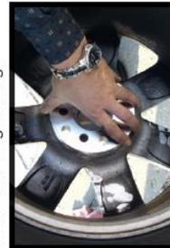
**9** Auch an der Achse muss die Distanzscheibe vollflächig anliegen.
